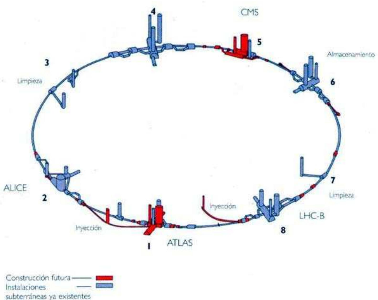
(FIG. 7.20) Esquema del túnel del LEP en que se indica la infraestructura existente y la que está en construcción para el LHC (gran colisionador de hadrones, Large Hadron Collider) en Ginebra, Suiza.
