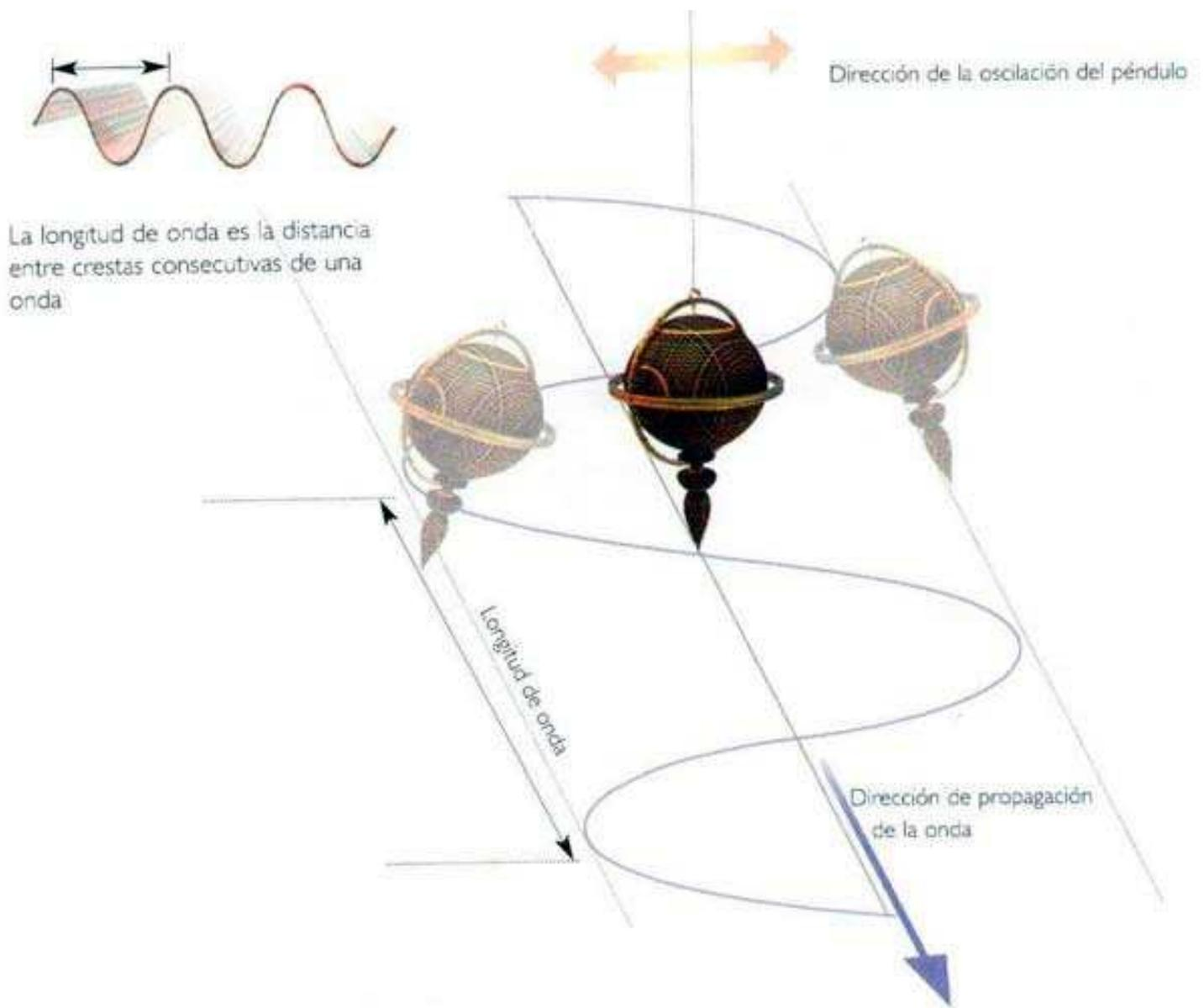
(FIG. 2.9) ONDA DE PROPAGACIÓN CON PÉNDULO OSCILANTE
