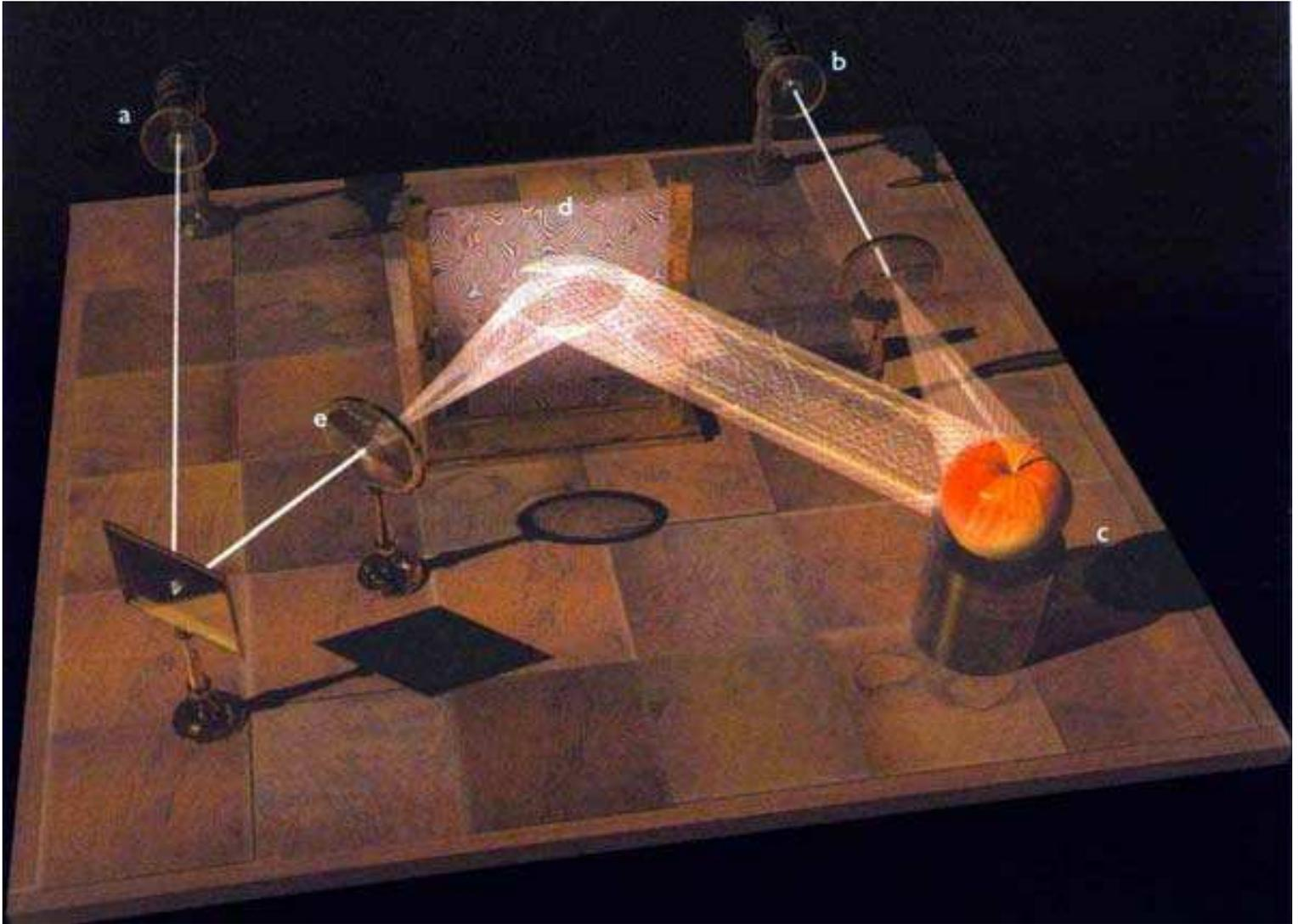
(FIG. 2.22) La holografía es esencialmente un fenómeno de interferencia de figuras ondulatorias. Los hologramas son producidos cuando la luz procedente de un láser es bifurcada en dos rayos separados (a) y (b). Uno de ellos (b) rebota en el objeto (c) e incide sobre una placa fotosensible (d). El otro (a) atraviesa una lente (e) y choca con la luz reflejada de b, produciendo en la placa una figura de interferencia.
